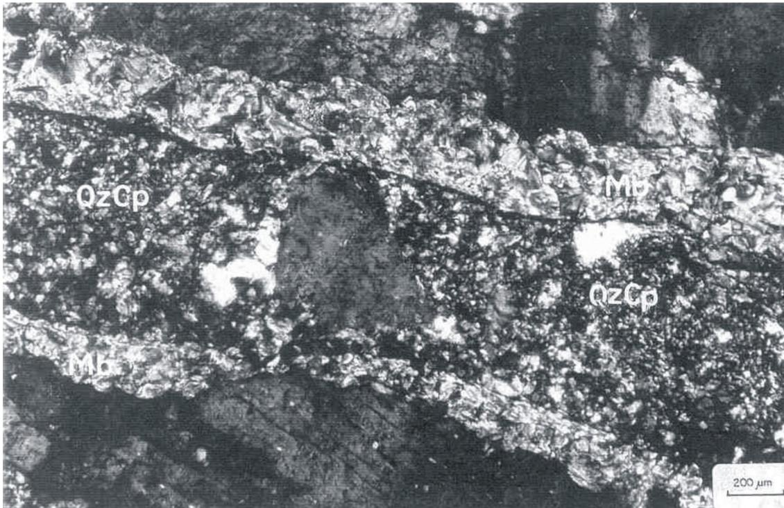
**Figura 7** - Fotomicrografia de quartzo criptocristalino reinfiltando veios de mica branca. QzCp = Quartzo Criptocristalino e Mb = mica branca. Luz Polarizada.
